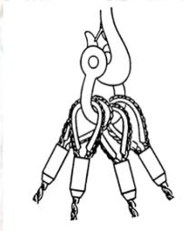
**Regra 2:** Quando conectar duas manilhas, faça a conexão do corpo com o corpo ou corpo com o pino. Nunca pino com pino.
