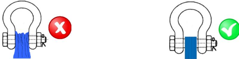
**Regra 7:** Quando usar cinta sintética com uma manilha certifique-se que a superfície de apoio da manilha esteja perfeitamente lisa sem aresta cortante ou superfície rugosa que possa danificar a cinta.
